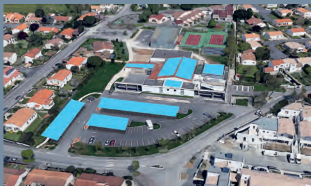
Des panneaux photovoltaïques sur le toit et sur le parking de l'EMC permettront d'alimenter les bâtiments publics à proximité.
