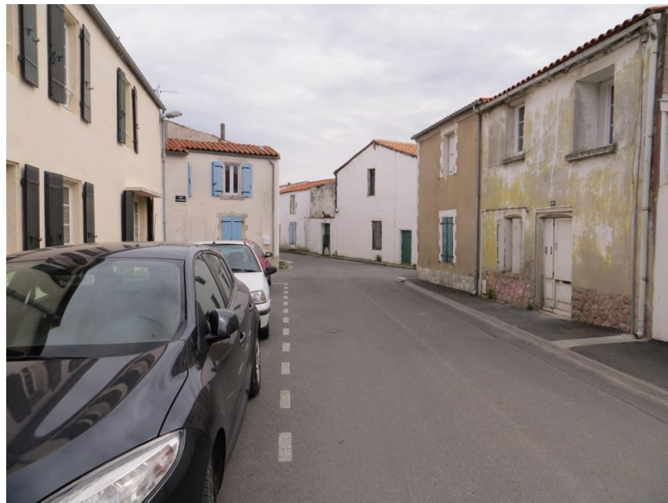
La partie centrale : tracé en plan sinueux, bâti en débordement, carrefours sans visibilité
